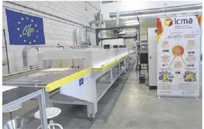
Las piezas, ya tratadas, salen del horno láser instalado en el CEEI Aragón. ICMA
